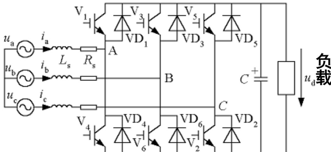
图7-32 三相桥式PWM整流电路
