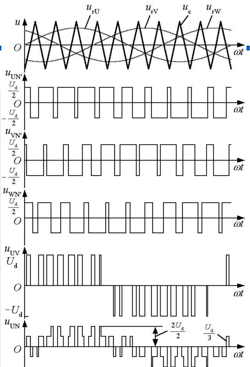
图7-8 三相桥式PWM逆变电路波形
