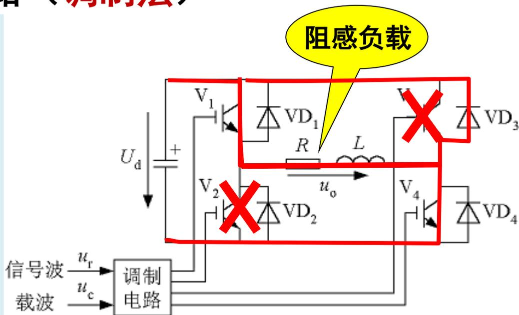
图7-4 单相桥式PWM逆变电路
