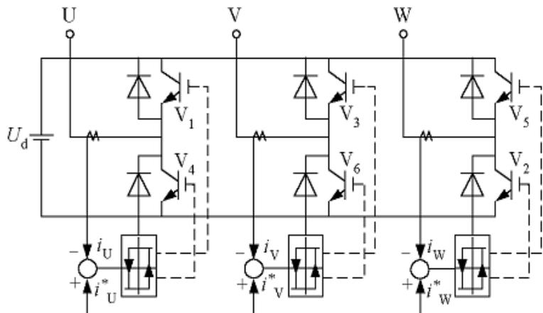
图7-26 三相电流跟踪型PWM逆变电路
