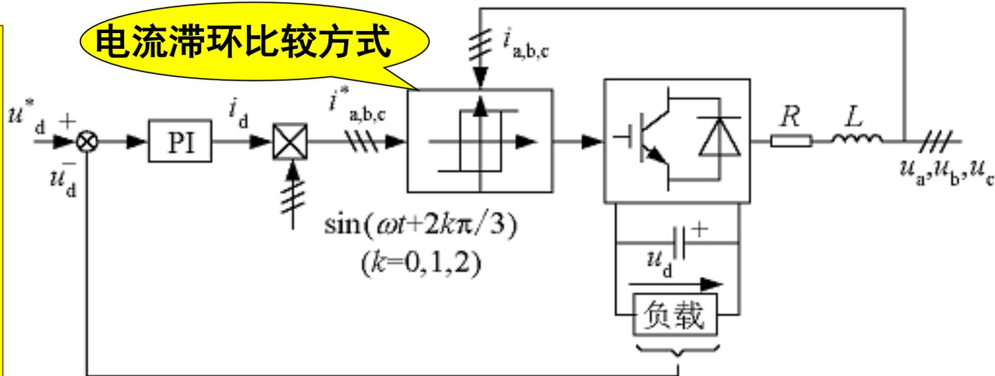
图7-34 直接电流控制系统结构图
