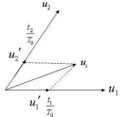
图7-21 空间电压矢量的线形组合
