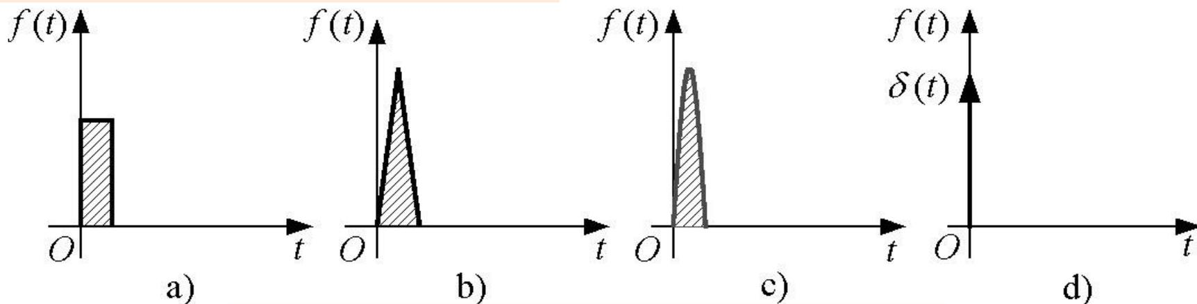
图7-1 形状不同而冲量相同的各种窄脉冲
