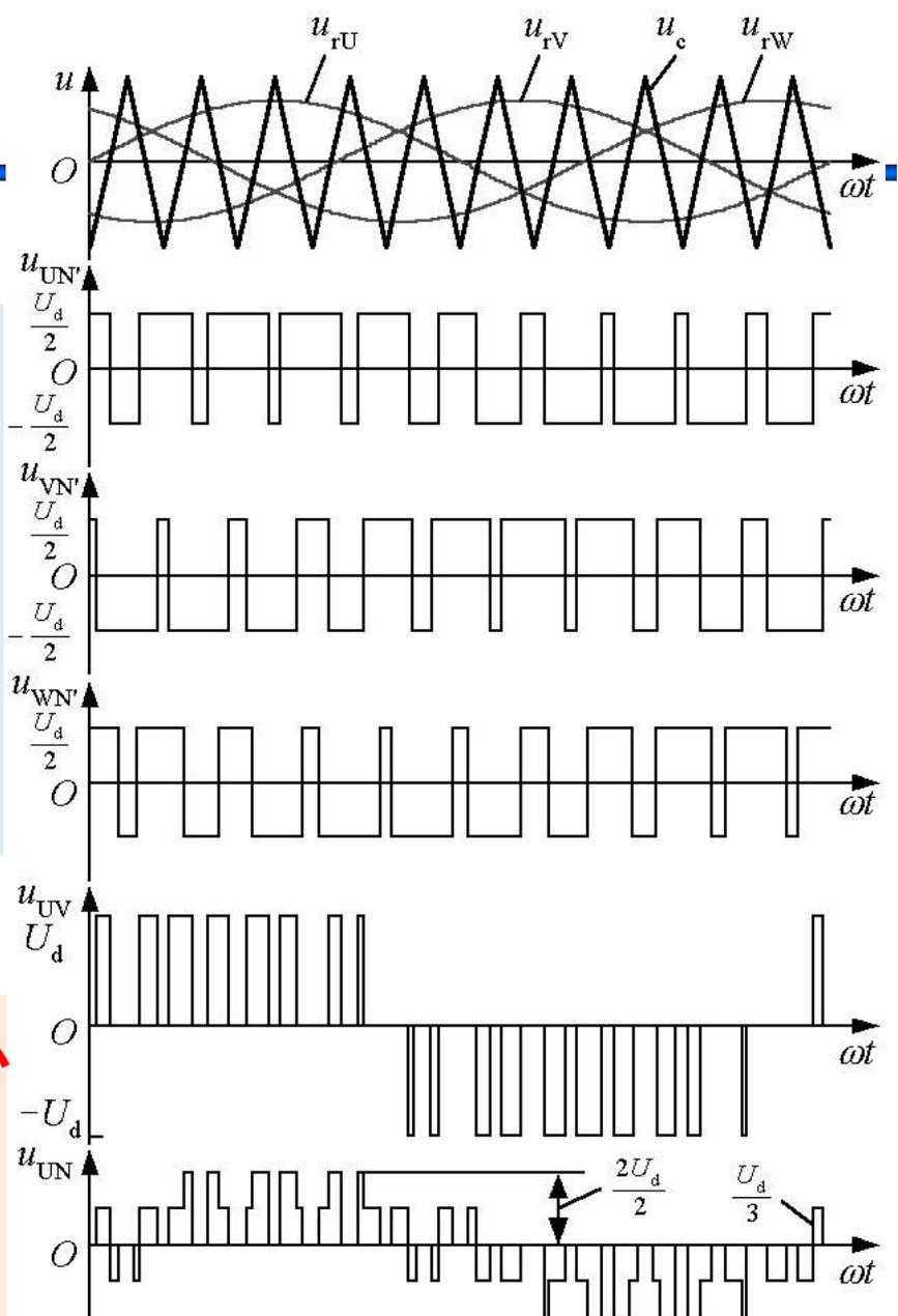
图7-8 三相桥式PWM逆变电路波形
