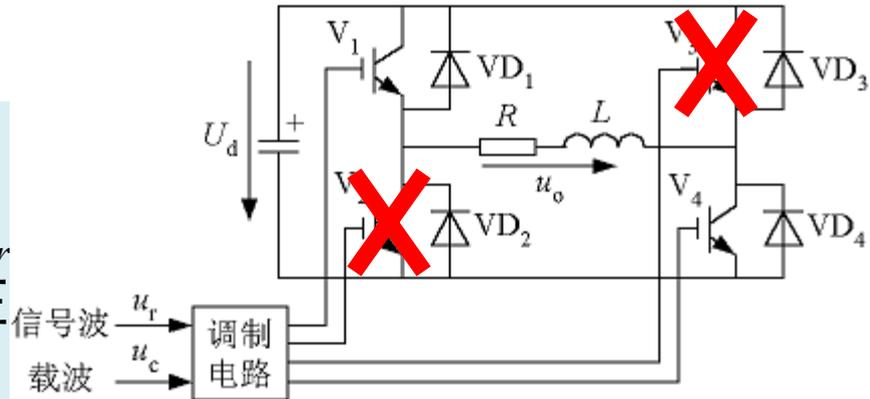
图7-4 单相桥式PWM逆变电路
