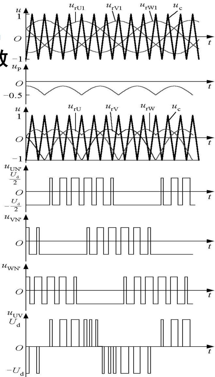
图7-19 线电压控制方式举例
