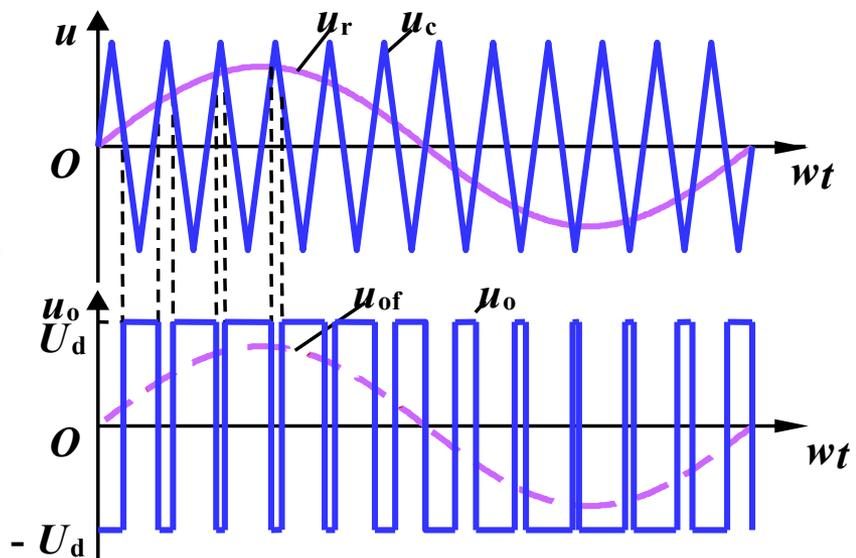
图7-6 双极性PWM控制方式波形
