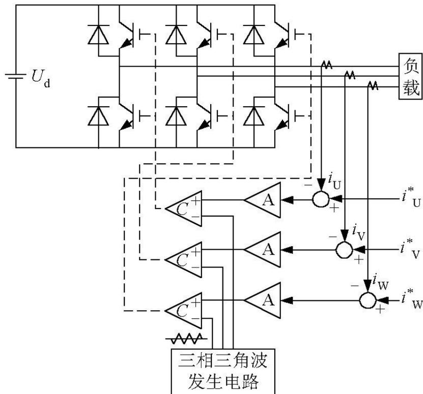
图7-29 三角波比较方式电流跟踪型逆变电路
