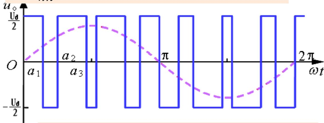
图7-9 特定谐波消去法的输出PWM波形
