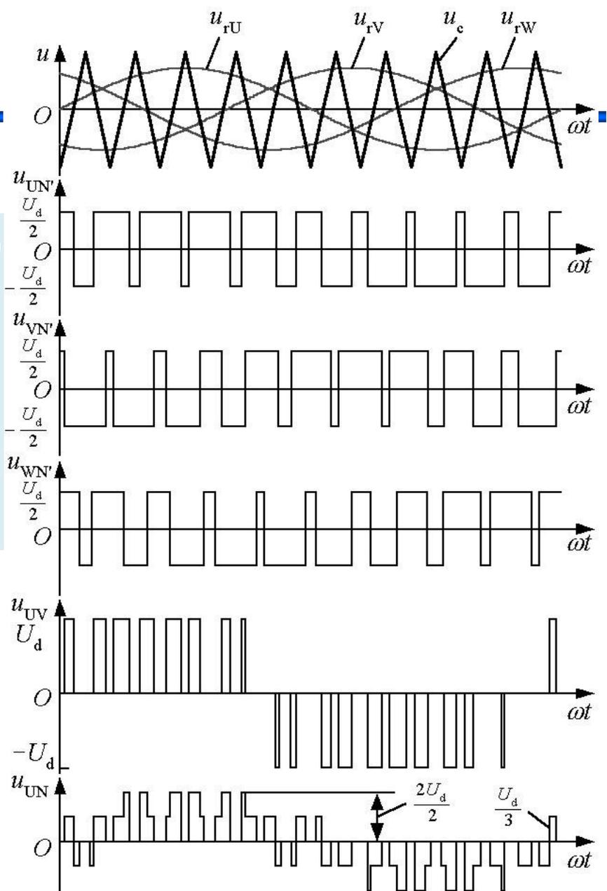
图7-8 三相桥式PWM逆变电路波形
