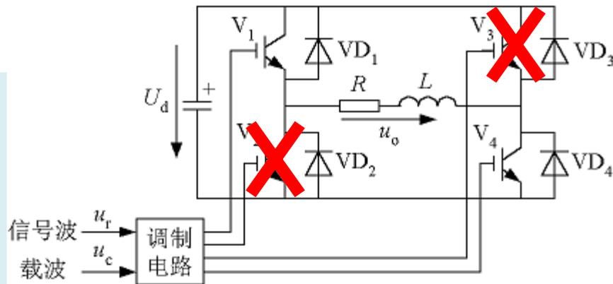
图7-4 单相桥式PWM逆变电路
