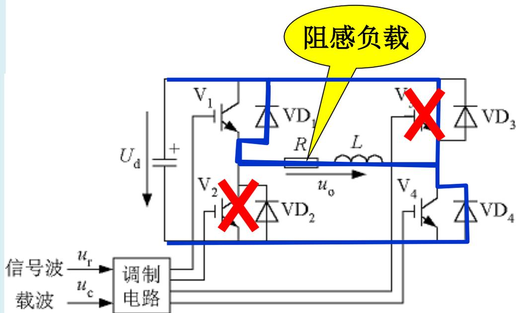
图7-4 单相桥式PWM逆变电路
