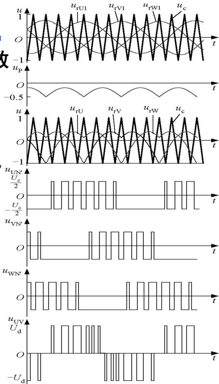
图7-19 线电压控制方式举例
