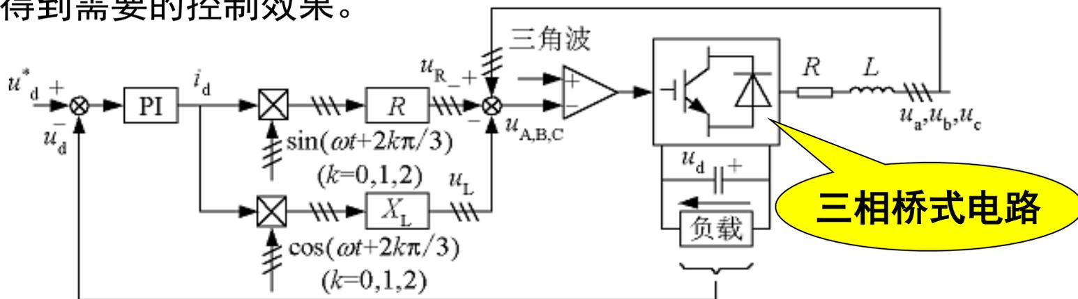
图7-33 间接电流控制系统结构
