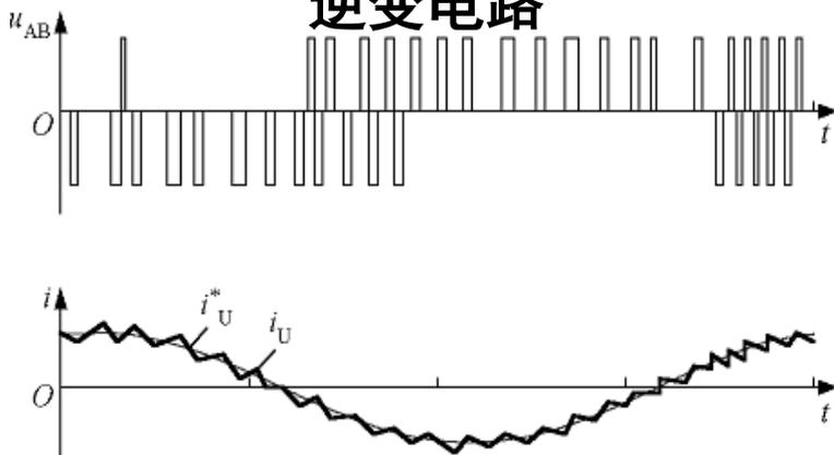
图7-25 滞环比较方式的指令电流和输出电流
