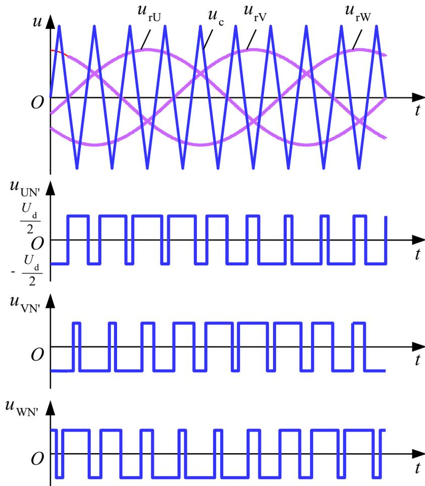
图7-10 同步调制三相PWM波形
