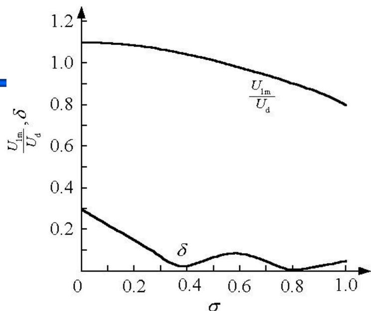
图7-16  $\sigma$ 变化时的 $\delta$ 和直流电压利用率
