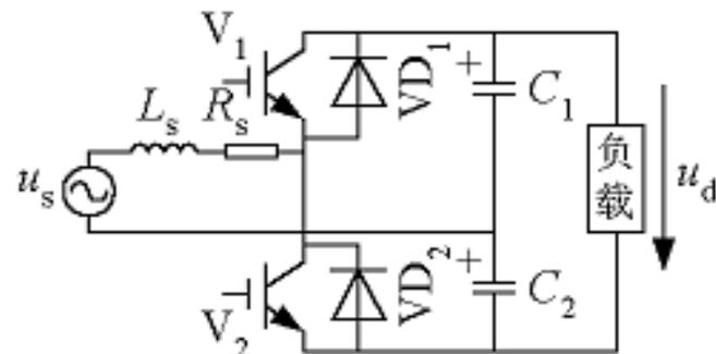
包括外接电抗器的电感和交流电源内部电感，是电路正常工作所必须的。
