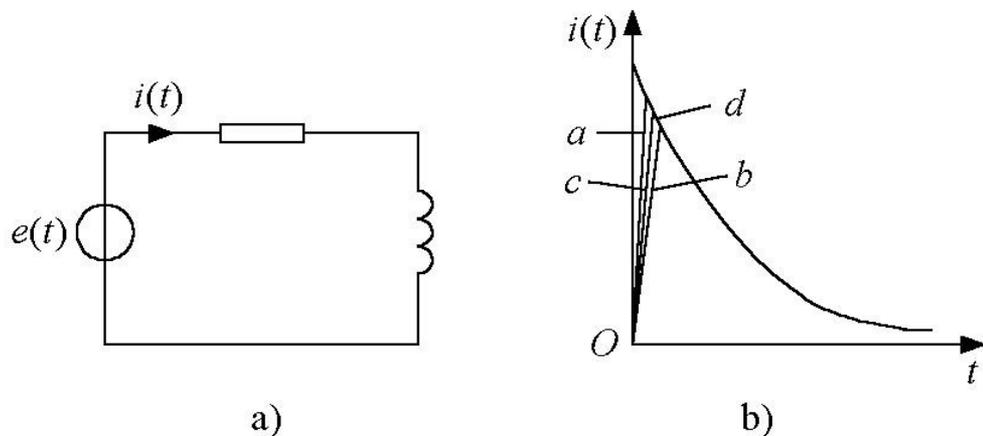
图7-2 冲量相同的各种窄脉冲的响应波形
