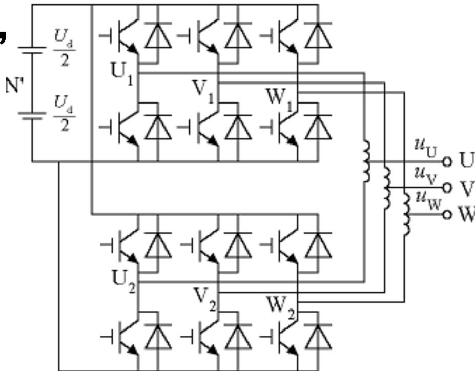
图7-22 二重PWM型逆变电路
