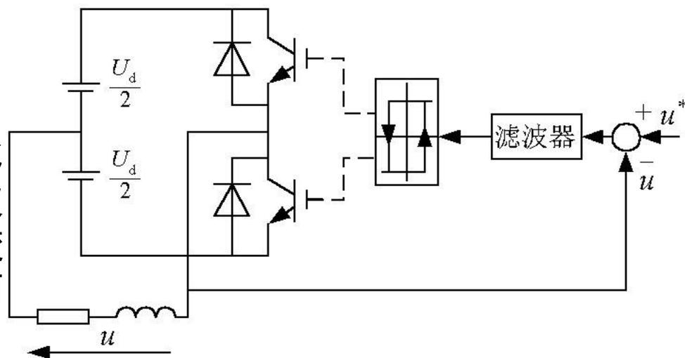
图7-28 电压跟踪控制电路举例
