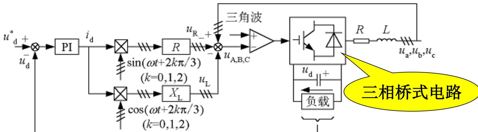
图7-33 间接电流控制系统结构
