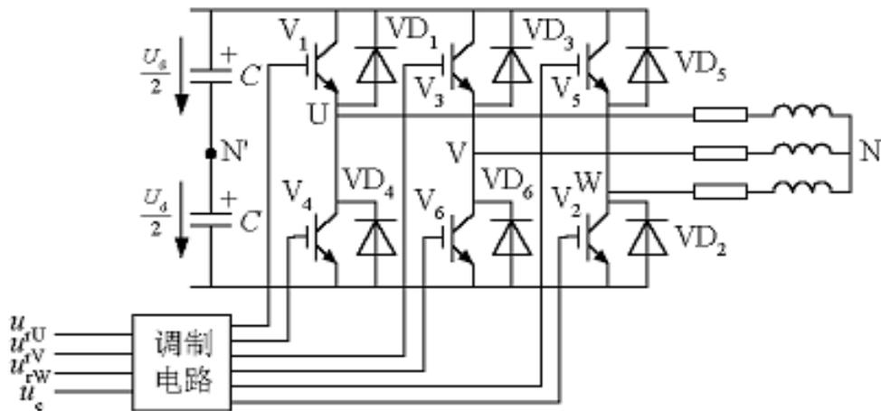
图7-7 三相桥式PWM型逆变电路
