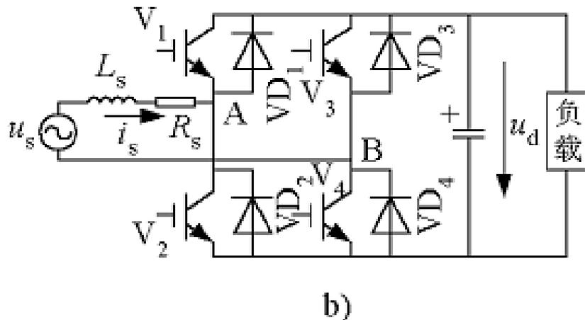
图7-30 b)单相全桥电路
