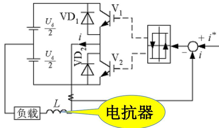
图7-24 滞环比较方式电流跟踪控制举例
