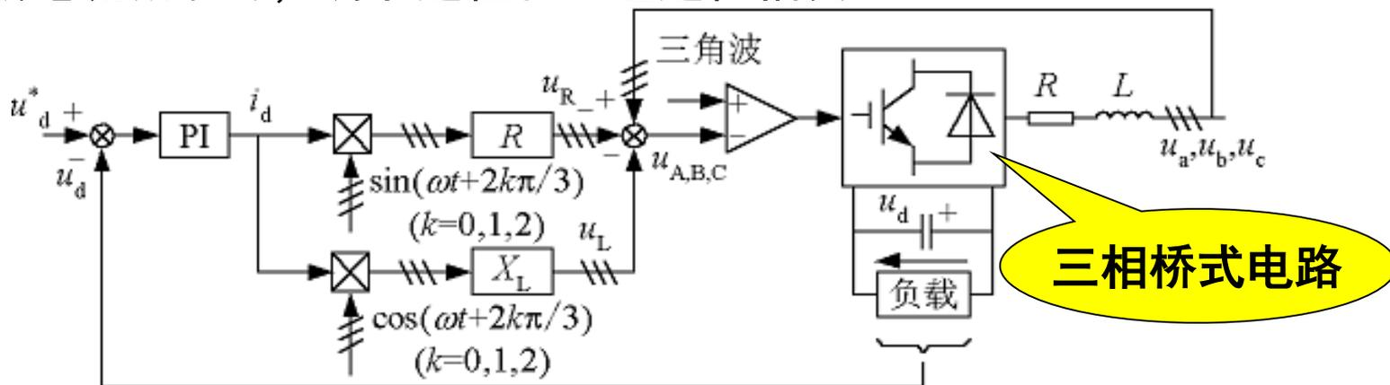
图7-33 间接电流控制系统结构
