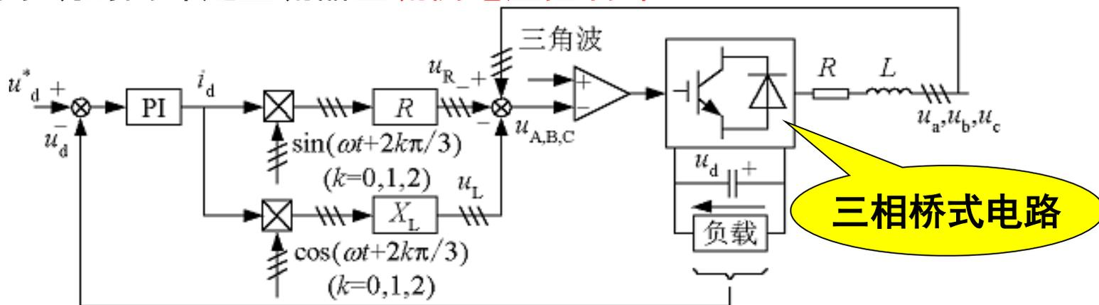
图7-33 间接电流控制系统结构
