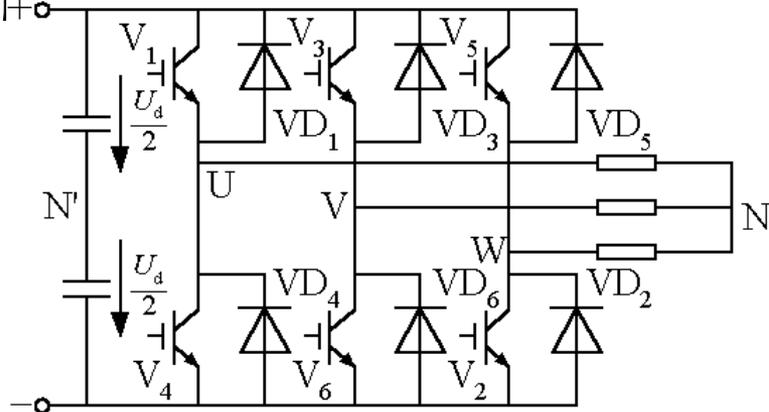
图4-9 三相电压型桥式逆变电路
