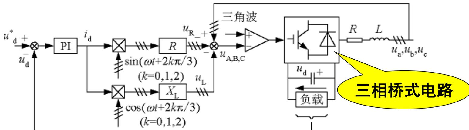
图7-33 间接电流控制系统结构
