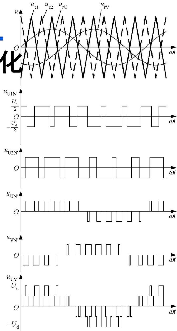
图7-23 二重PWM型逆变电路输出波形 49
